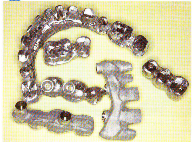
fig.1 : CAD/CAMによる削りだしフレーム、アズミリングの状態。
